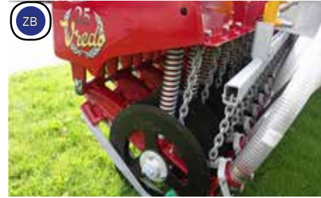
Mechanische bodemvolgving, voor optimale bodemaanpassing.
