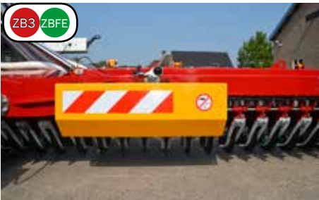
Reflecterende, automatische schijfafscherming
