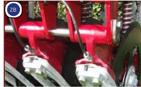
1 scharnierpunt, voor minimale slijtage en optimale werking.
