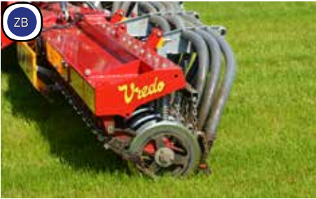
Compacte bouw, neemt weinig ruimte inbeslag, zwaartepunt kort bij machine
