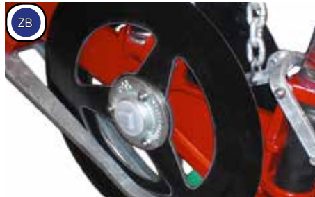
Smeerbare hoek contactlagers, voor lange levensduur
