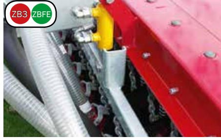
Hydraulisch afsluiters voor schone werking.
