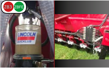
Automatisch smeersysteem voor lage onderhoudskosten.
